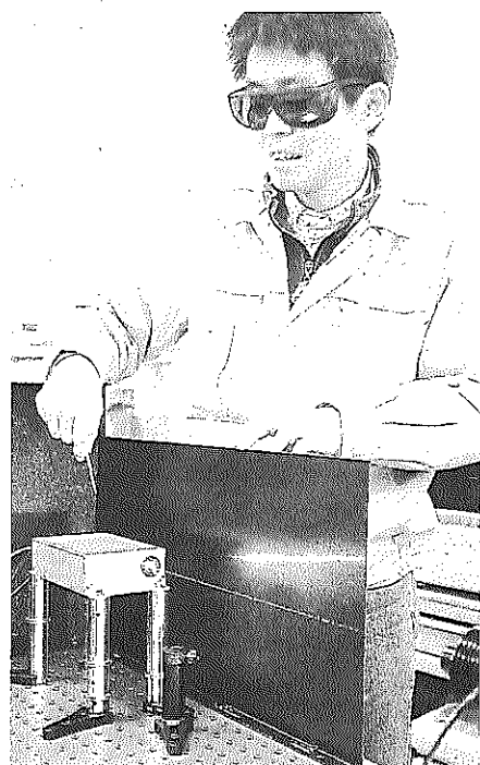
結晶が内蔵された四角い装置に1064ナノメートルの目に見えない波長のレーザー光を通すと、波長532ナノメートルの緑色のレーザーが生み出される
